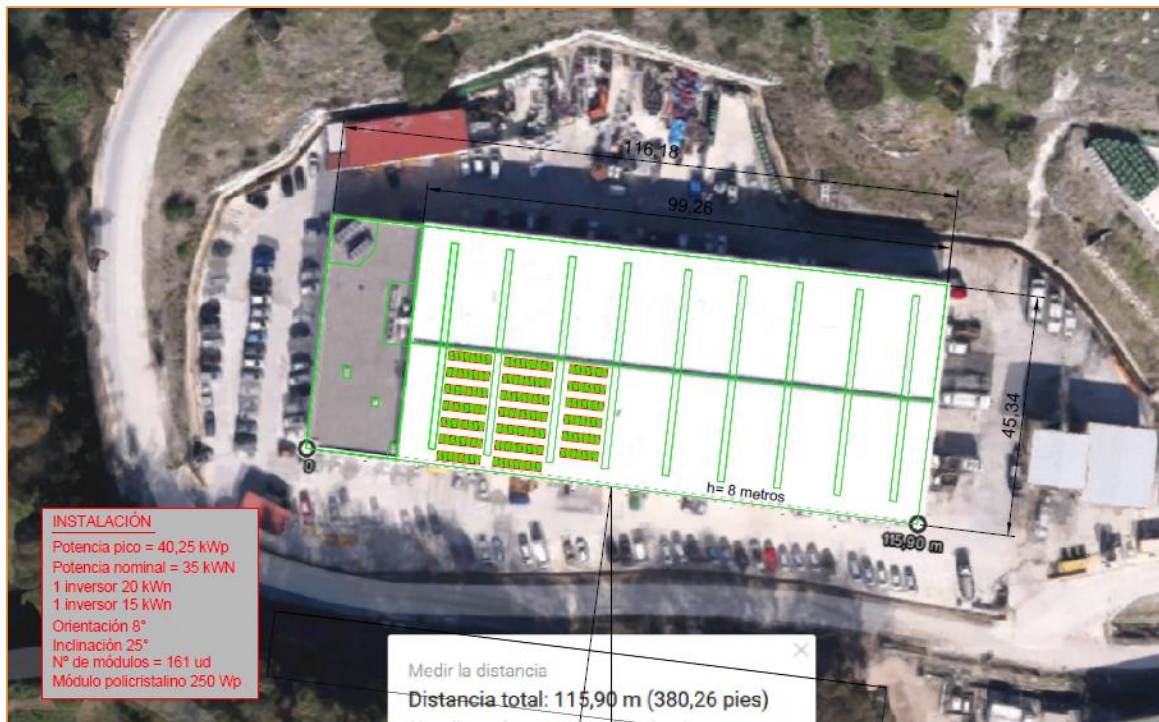
Imagen 5 Ubicación de los módulos en cubierta
