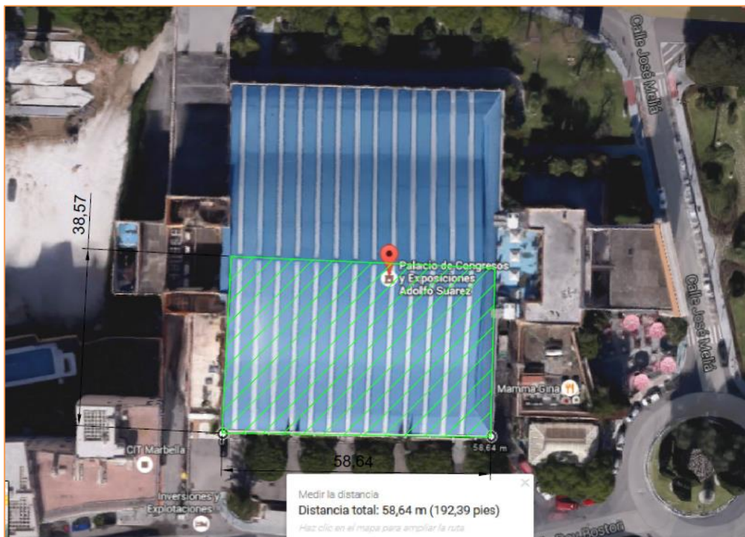
Imagen 4 Cubiertas consideradas para la implantación de los módulos fotovoltaicos
