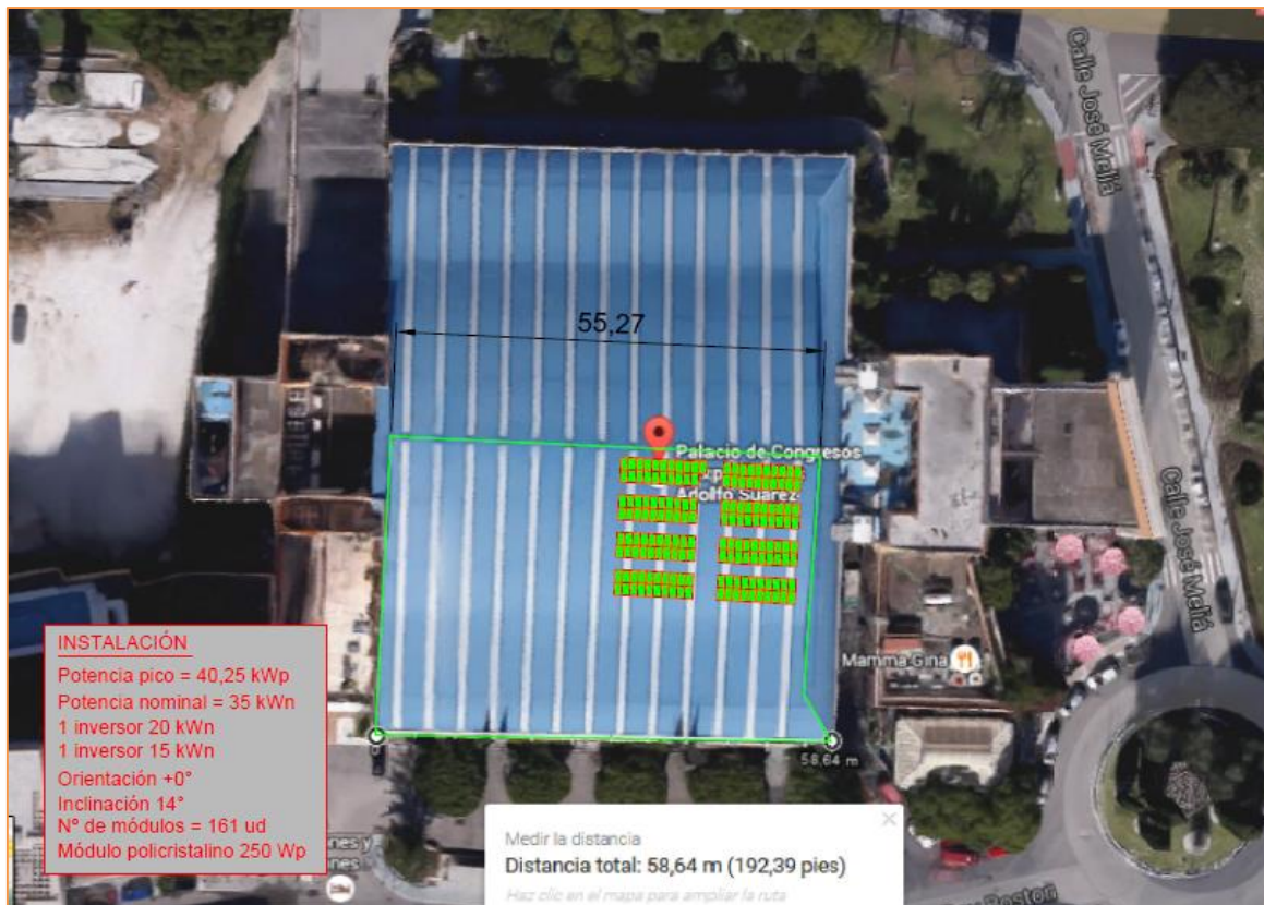
Imagen 5 Ubicación de los módulos en cubierta
