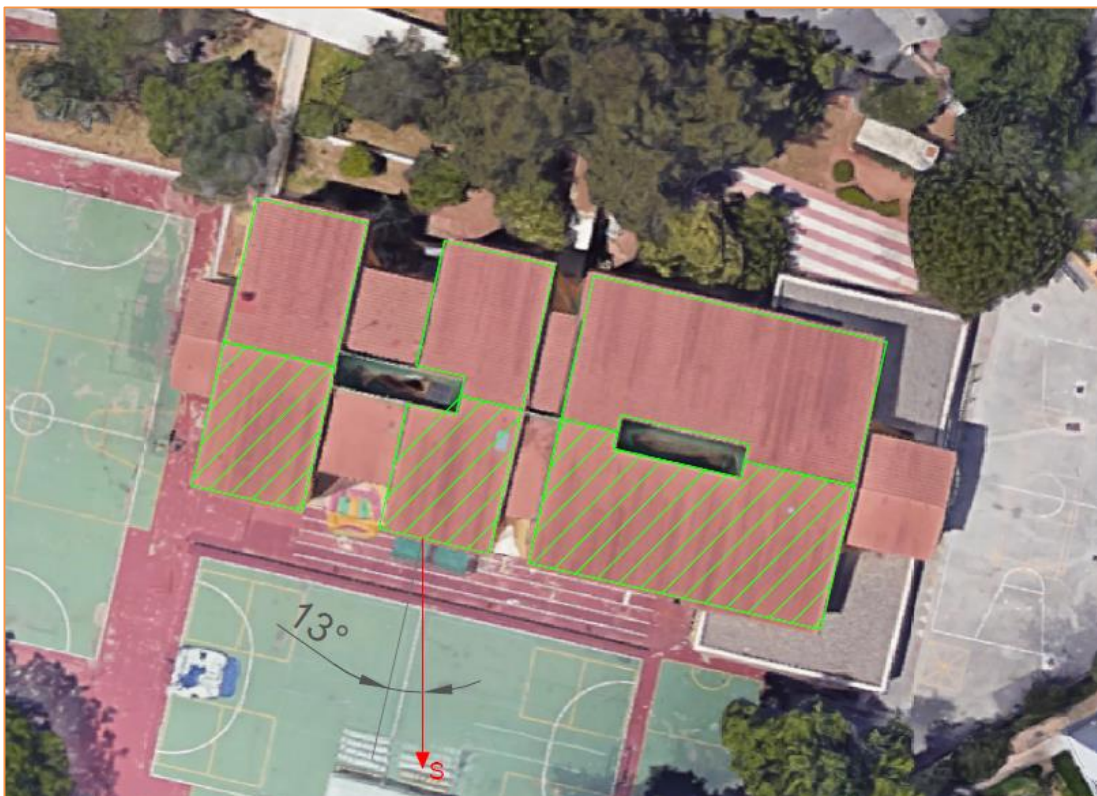
Imagen 4 Cubiertas consideradas para la implantación de los módulos fotovoltaicos
