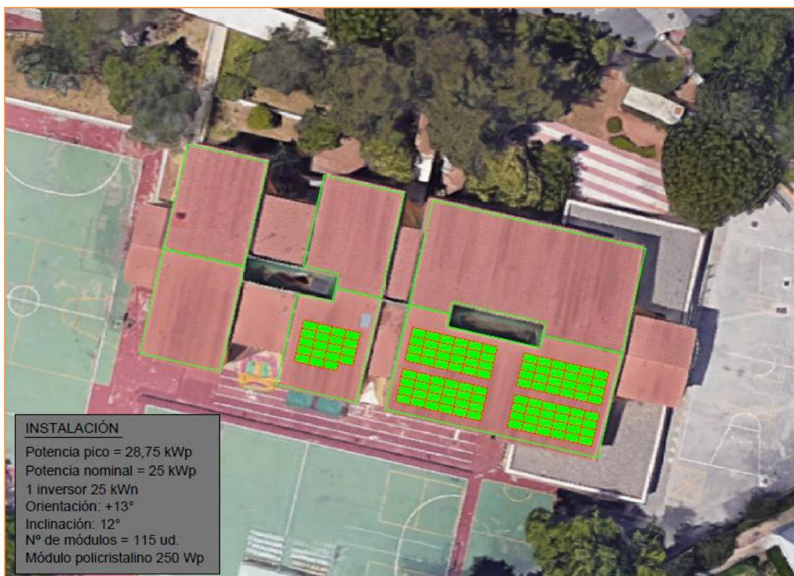
Imagen 5 Ubicación de los módulos en cubierta
