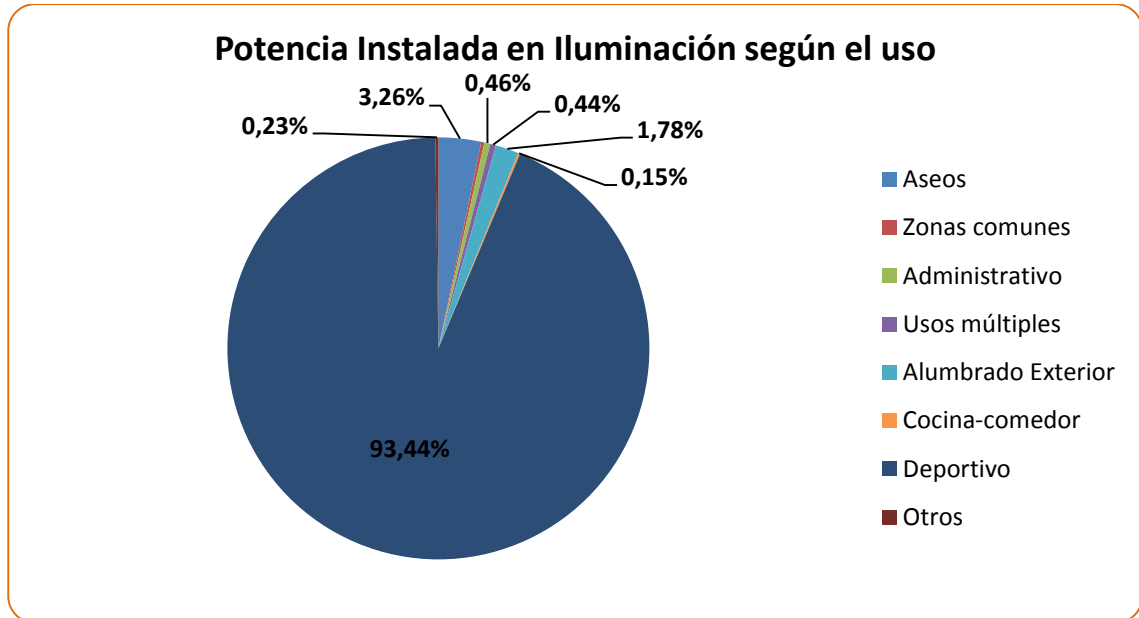
Gráfico 2 % Potencia instalada en iluminación según el uso
